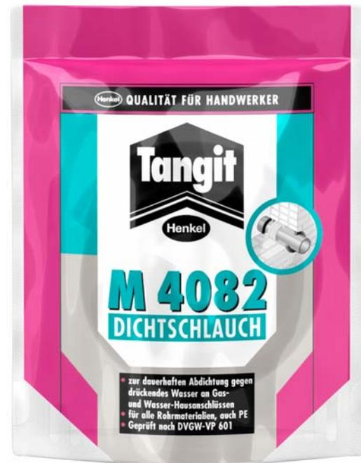
Den Tangit Dichtschauch M 4082 auf der Hauseinführung/Hausanschlussleitung mit mindestens 3-facher Wicklungszahl umwickeln und den Tangit Dichtschauch M 4082 formschlüssig in den Ringraum pressen. Äußerer Abstand Außenwand und Tangit Dichtschauch M 4082: ca. 50mm.
